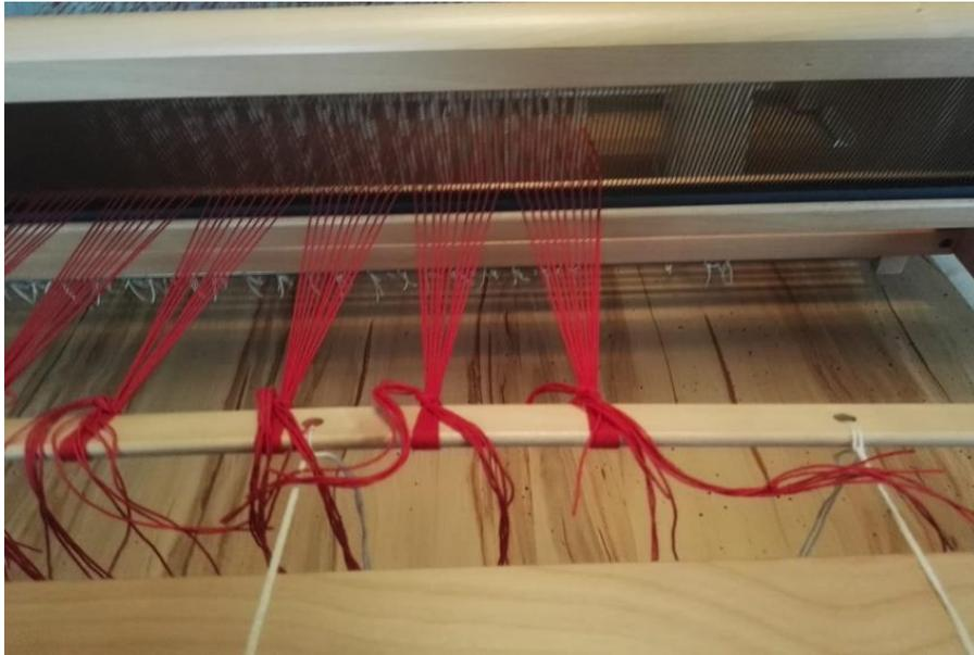
Dann müssen die ganzen Kettfäden noch durch den vorderen Kamm eingezogen werden. Anschliessend werden sie mit dem Warenbaum verknüpft. Damit sind die Vorbereitungen abgeschlossen.
